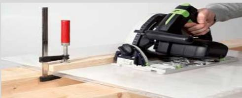
Das Anzeichnen erfolgt am besten auf der Schutzfolie. Diese sollte auch für die weitere Bearbeitung bis nach der Montage auf der Platte bleiben. Die Stegplatten sollten gegen Flattern eingespannt sein und es ist möglichst mit Anschlag z.B. Holzleiste zu arbeiten, um das Verkanten der Säge, und dadurch Unfallgefahren sowie mögliche Beschädigungen der Sägekante der Stegplatte zu vermeiden.
